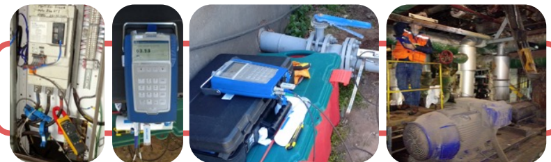
Figura 6: Medición de flujos incompresible y limpios, con caudalímetro ultrasónico
