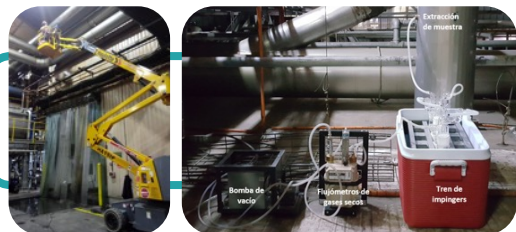
Figura 1: Medición de flujos gaseosos y contenido de humedad en vahos
